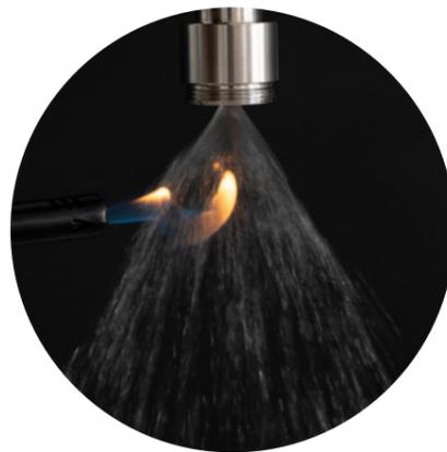
Flamme eines Feuerzeugs im Sog der Wirbelkammer
